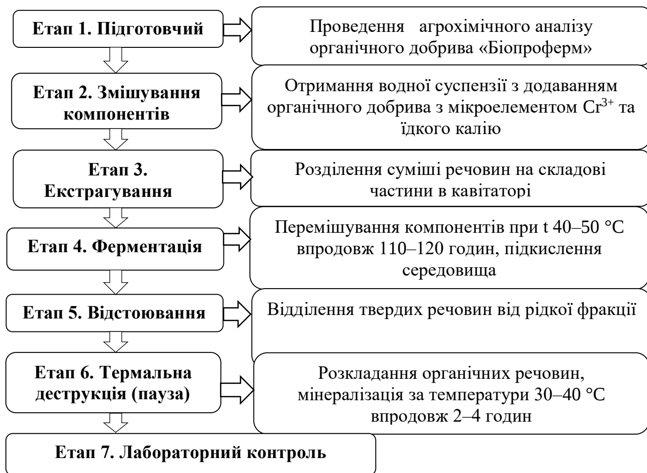
Рис. 5. Технологія виробництва рідкого органічного добрива «Біохром»
