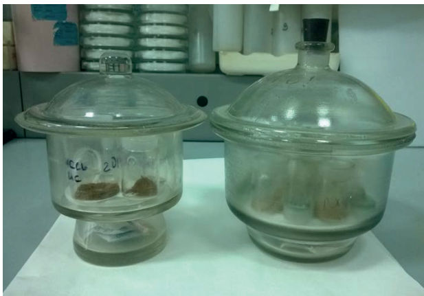
Рис. 1. Висушування уредініоспор збудника бурої іржі в ексикаторі з силікагелем
